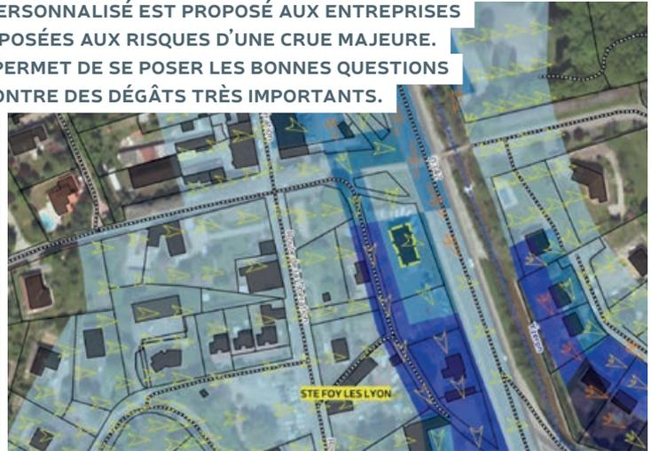
Simulation des niveaux de submersion en cas de crue centennale.
