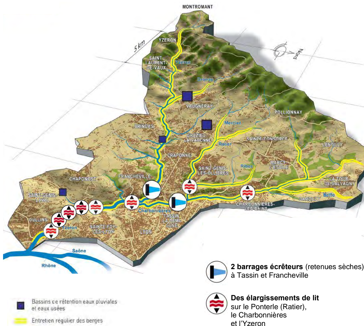
Carte 6 : Implantation et principe des travaux de protection contre les inondations
