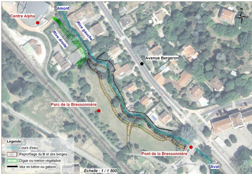
Figure 16 : Représentation des aménagements de cours d'eau à Charbonnières les Bains (vues orthophotographiques)
