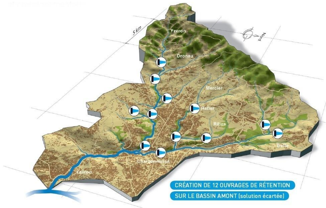
Carte 24 : Solution alternative écartée n°1 – Projet d'écrêtement des crues par la réalisation de plusieurs ouvrages de rétention
