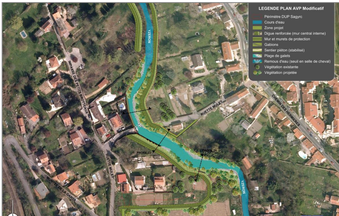
Figure 19 : Représentation des aménagements de cours d'eau à Ruette Mulet à Francheville (vue orthophotographique et coupe habillée)
